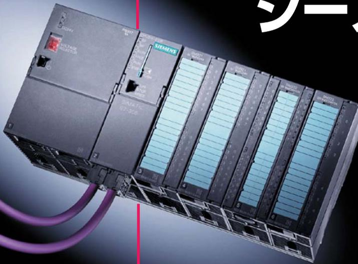
汎用PLC世界シェアNo.1のシーメンスが誇るディスクリット用途に最適なPLC「SIMATIC S7-300」シリーズ。PROFIBUS-DPインターフェースを備えていて、DPマスターポートとしてスレーブを接続したり、リモートI/Oによる分散システム構築が行えます。また、DPスレーブ局として使用することもできます。
