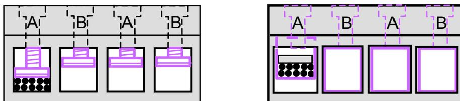
図 13 : ネジ端子 - ワイヤエンドフェルールを使わずに撚り線ケーブルを固定できる
